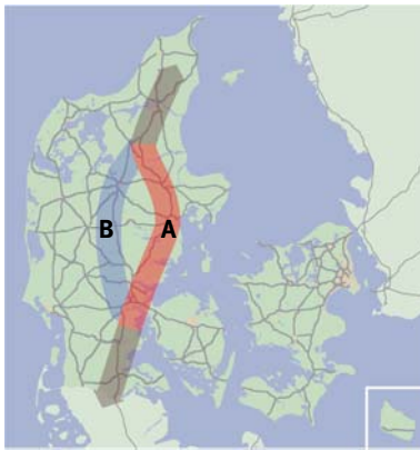
Figur 3: Trængselsproblemerne i Midtjylland kan løses ved enten at udvide den eksisterende E45-motorvej (A) eller ved at anlægge en ny midtjysk motorvejskorridor (B).
