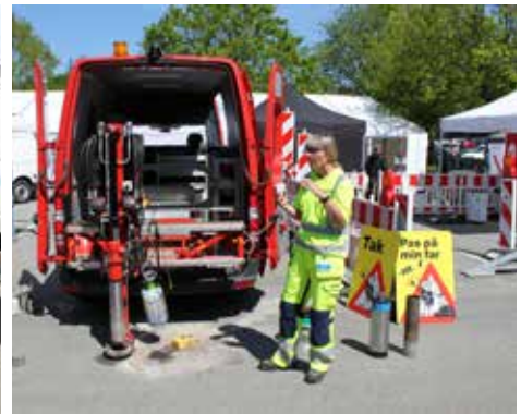
NCC demonstrerede, hvor let og hurtigt en asfaltprøve kan opbores fra vejen med firmaets borevogn.
