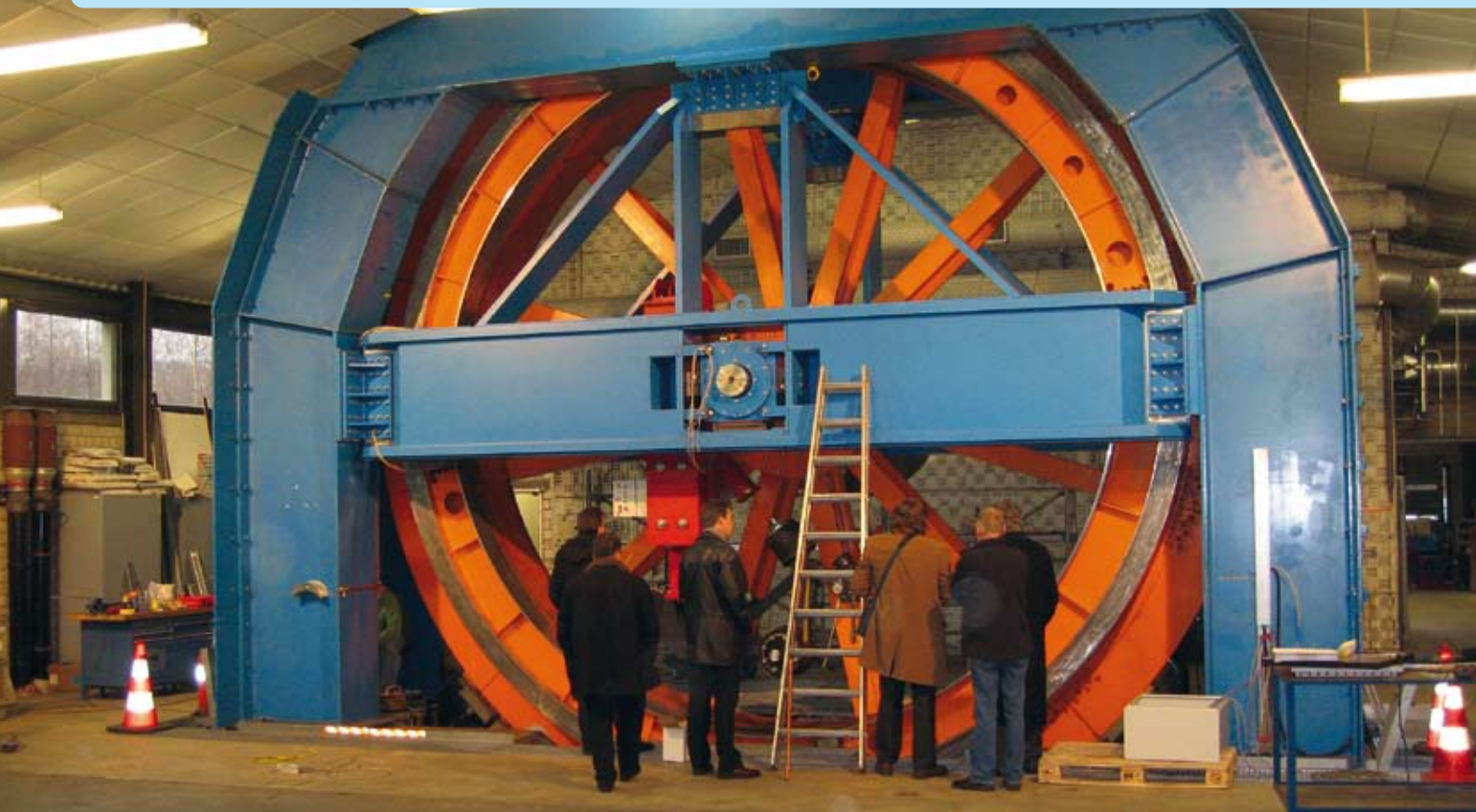
I forbindelse med Silence-projektet udviklede VI's tyske søsterorganisation, BASt, denne testtromle. Den har en diameter på ca. 5 m, og udstyret med prøver af den givne vejbelægning kan teknikerne måle rullestøjen i tromlen ved forskellige hastigheder, f.eks. 30, 50 og 80 km/t, og på den måde rangordne belæggingerne.
