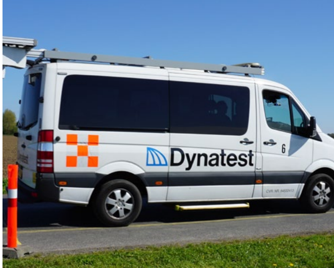
➤ Dynatest målevogn med laserudstyr.
