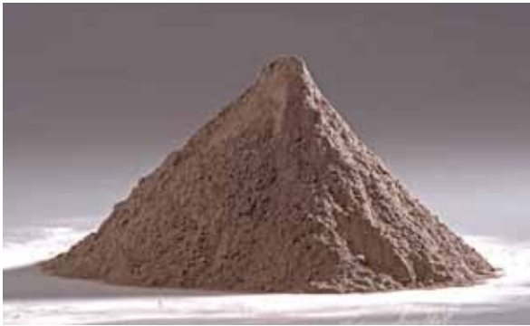
Flyveaske kan bruges som såkaldt filler i varmblandet asfalt.
