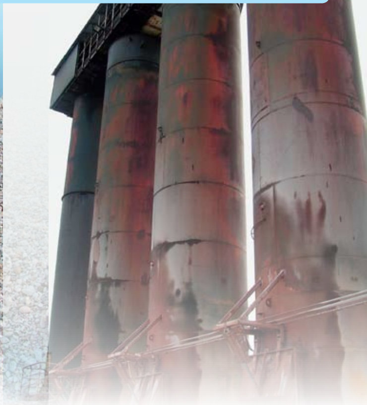
I disse høje brændes flintestenen ved 1.200 graders varme.
