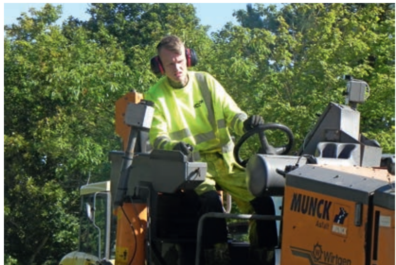
Stor koncentration under den praktiske del af prøven, hvor eleverne har mulighed for at vise deres praktiske kunnen. Eleverne arbejder sammen i hold af 4-6 personer og der skal både afrettes et stykke vej samt lægges nyt slidlag på i 2 baner.
