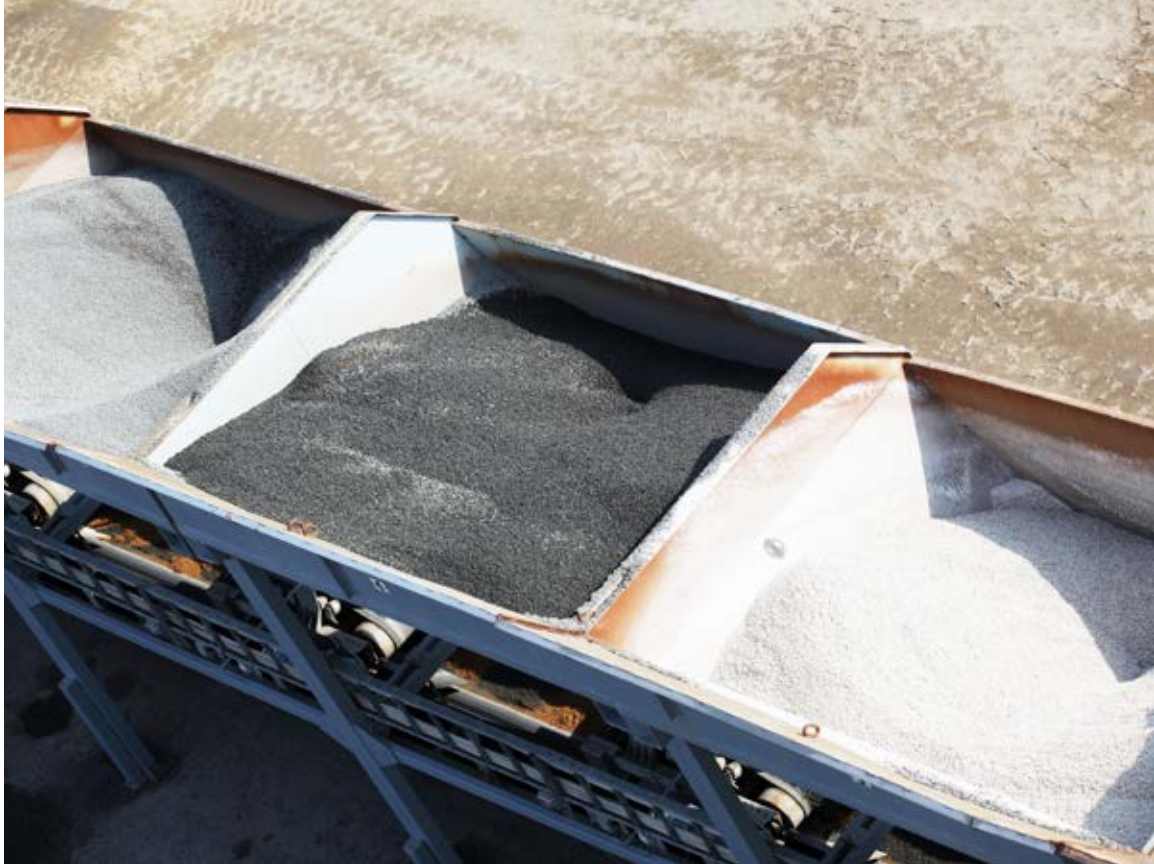
Kolddoseringsanlæg med stenmaterialer på asfaltfabrik
