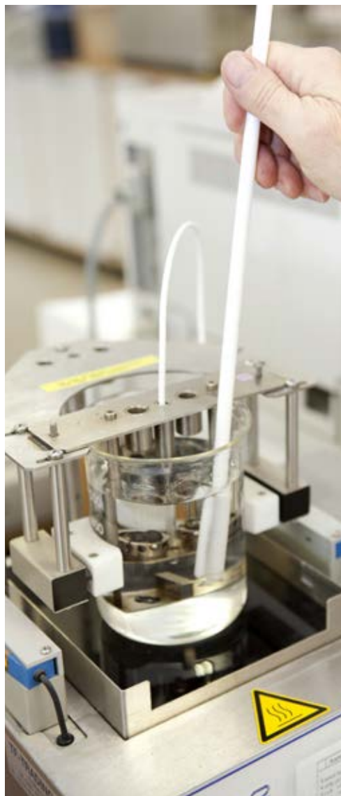
Måling af blødhedspunkt – kugle og ring
