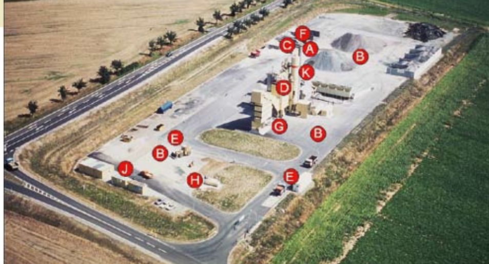
Figur 2: Oversigt over et asfaltanlæg med angivelse af mulige emissionskilder.
