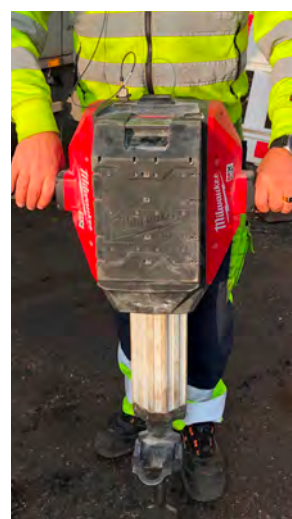
Måling af vibrationer fra henholdsvis en benzindrevet (t.v.) og batteridrevet (t.h.) hammer. Vibrationerne opfanges af en sensor, som er anbragt på toppen af den håndholdte maskine.
