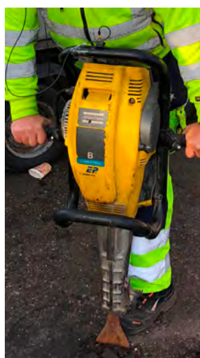
Måling af vibrationer fra henholdsvis en benzindrevet (t.v.) og batteridrevet (t.h.) hammer. Vibrationerne opfanges af en sensor, som er anbragt på toppen af den håndholdte maskine.
