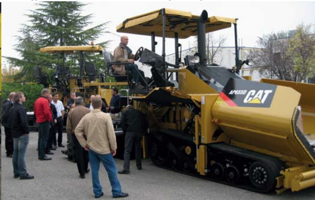
De danske maskinfolk fik demonstreret manøvreduktigheden af Caterpillar's AP655D-udlægger med den nye såkaldte Mobil-trac undervogn med et gummibåndsbælte.
